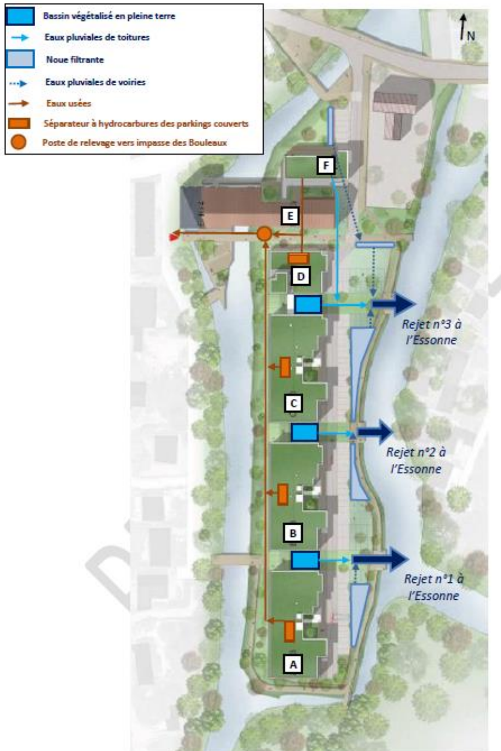
Figure 19: Schéma de principe de gestion des eaux pluviales et des eaux usées
